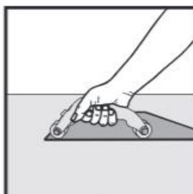
Mettre en place la première dalle en suivant les axes de pose et en marouflant.
